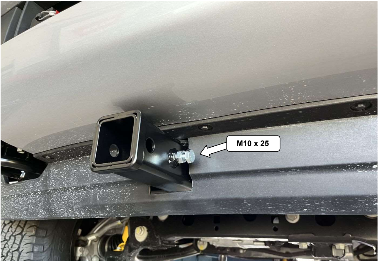
14 Sicherungsschraube eindrehen und abkontern! Turn in the locking screw and lock it!
