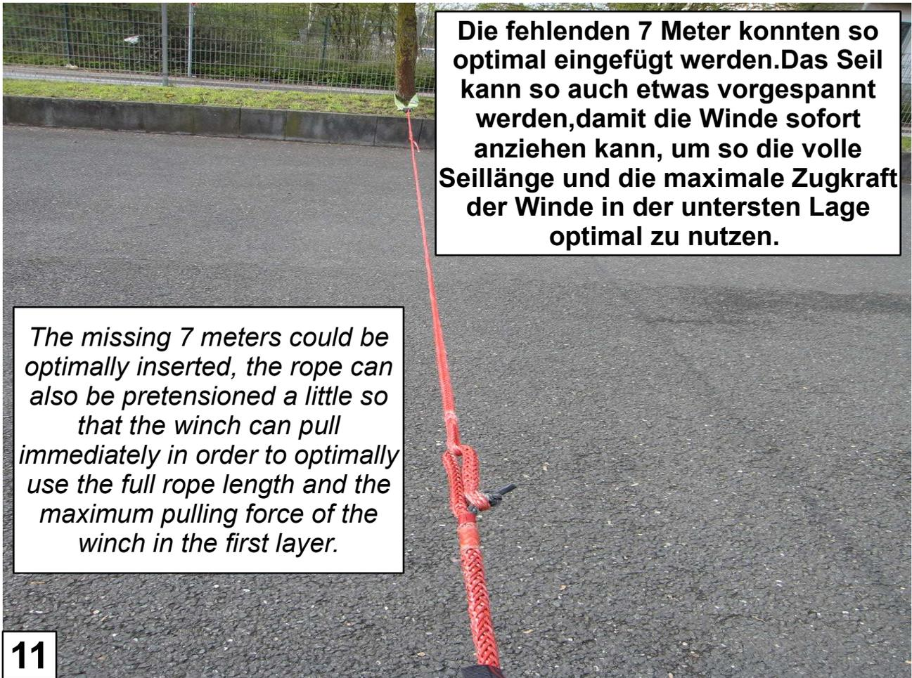
**Die fehlenden 7 Meter konnten so optimal eingefügt werden. Das Seil kann so auch etwas vorgespannt werden, damit die Winde sofort anziehen kann, um so die volle Seillänge und die maximale Zugkraft der Winde in der untersten Lage optimal zu nutzen.**
