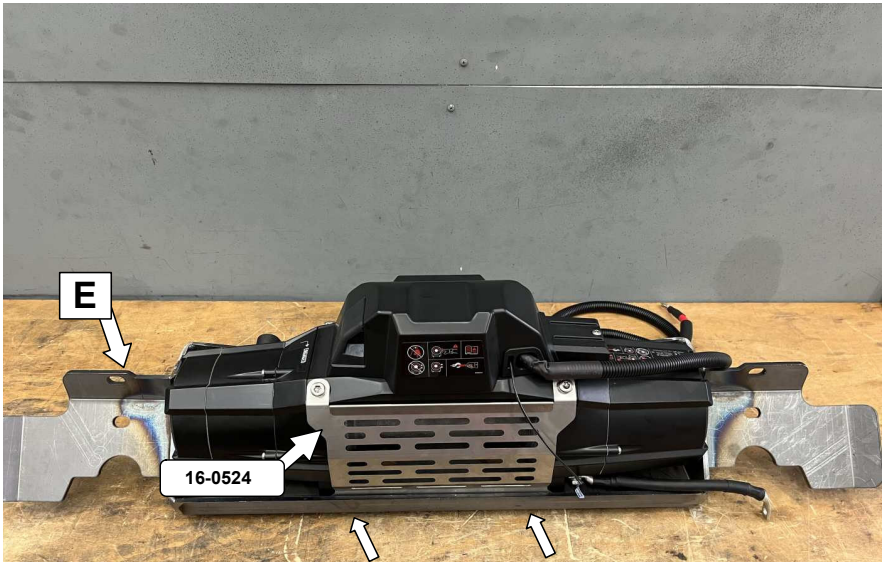
Seilwinde mit dem Kühlerschutzblech (Anleitung beachten) in die Seilwindenaufnahme setzen und nur mit den hinteren beiden Windenschrauben befestigen! / Place the cable winch with the radiator guard (follow the instructions) in the cable winch mount and fasten only with the two rear winch screws!
