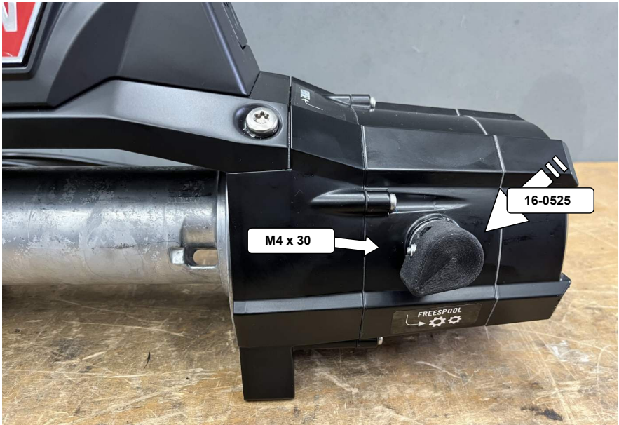
17 Schaltknopf, wie gezeigt, aufsetzen und verschrauben! Fit and screw on the gear knob as shown.
