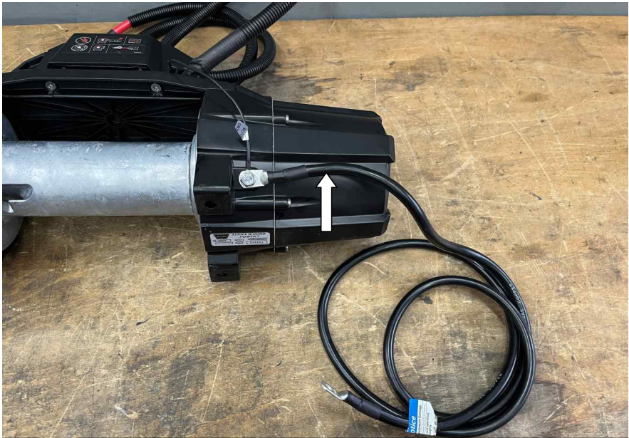
18 Original Massekabel entfernen! / Remove original earth cable!
