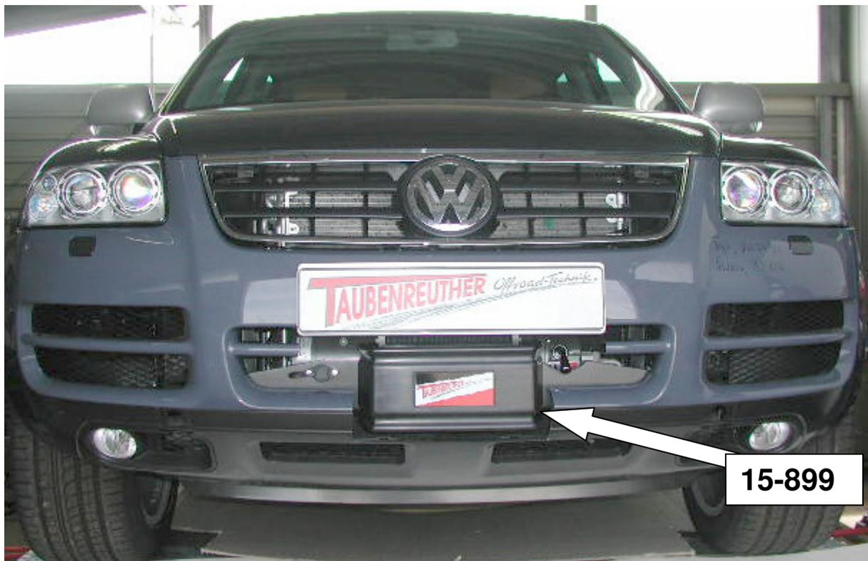
Hier sehen sie den fertig montierten Seilwindenanbausatz.
