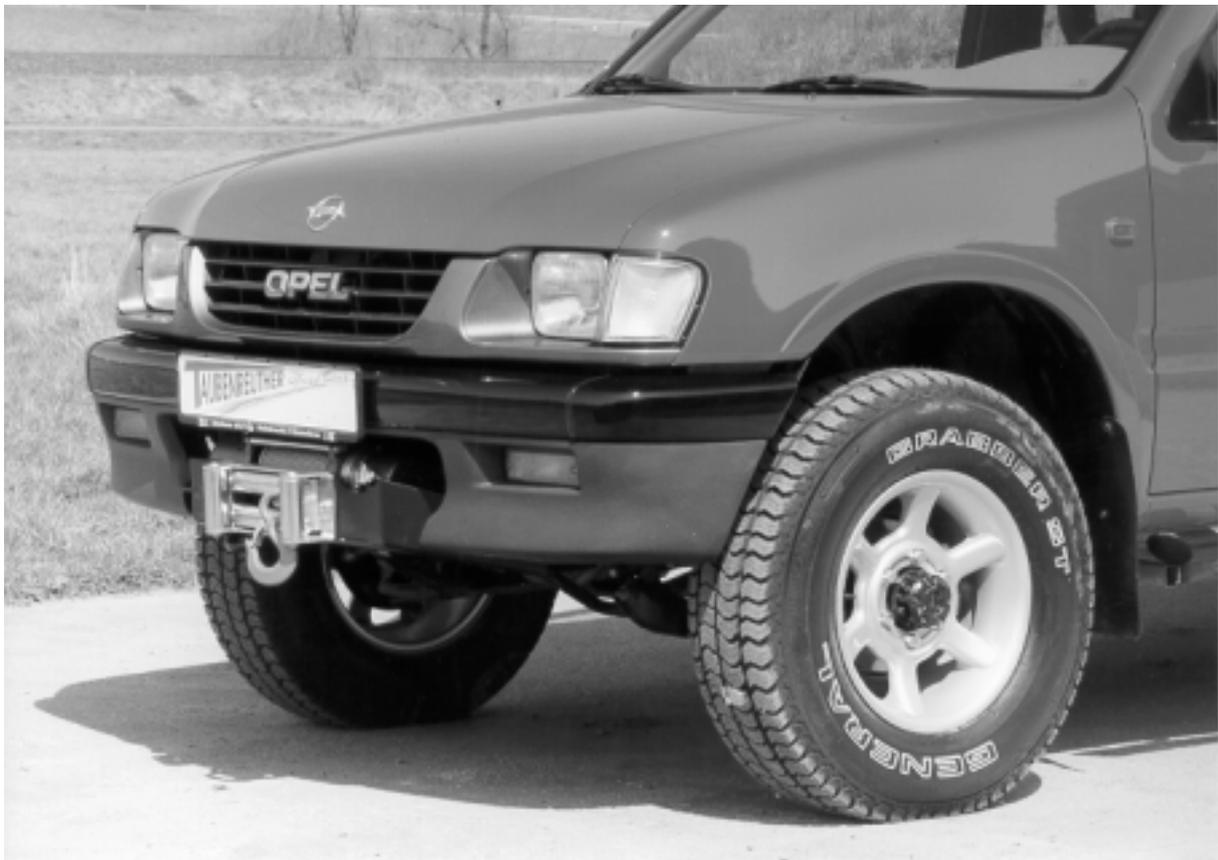
**Hier sehen sie den fertig montierten Seilwindenanbausatz 16 – 800.
