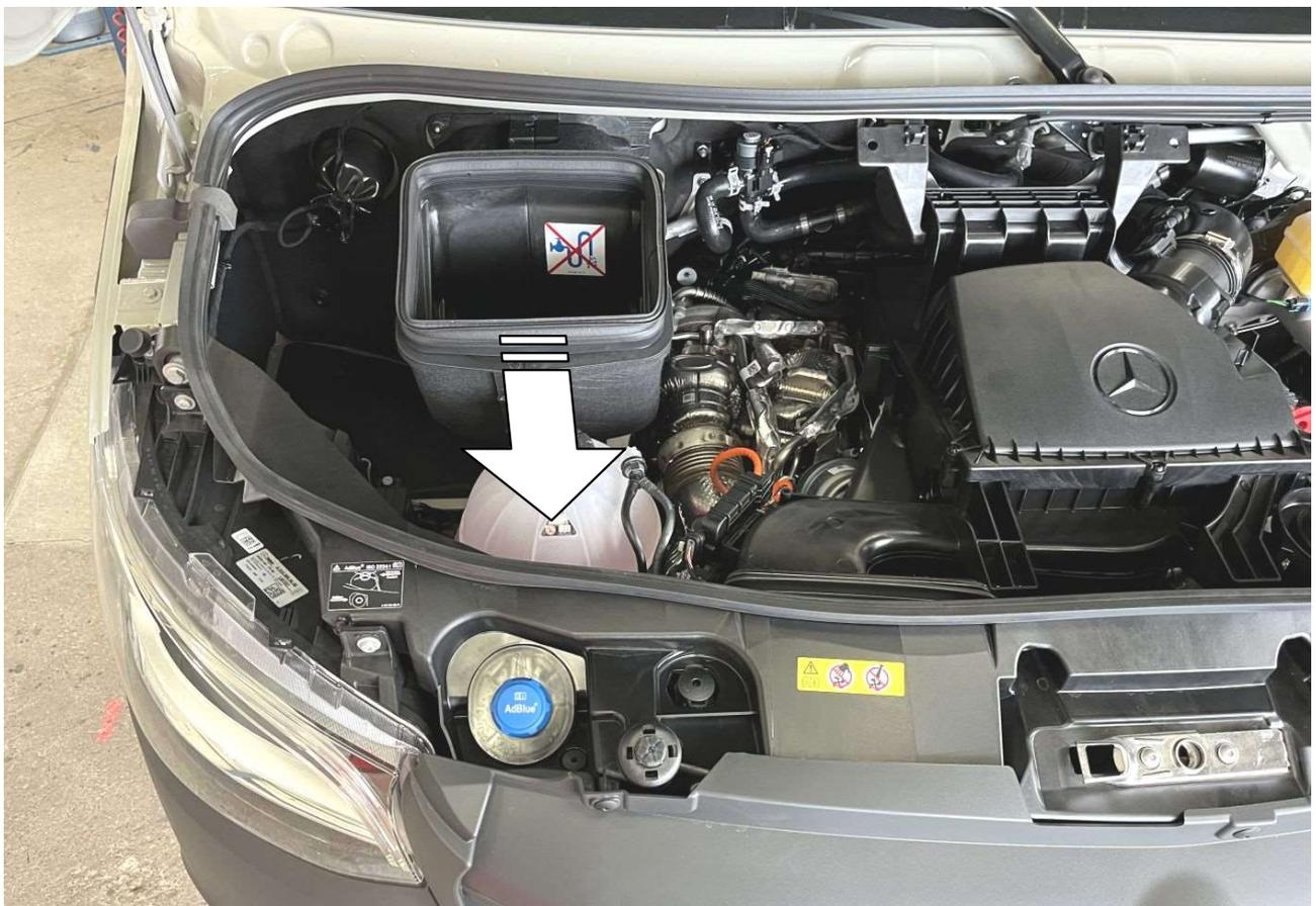
**4** Luftkanal entfernen! / Remove the air duct!
