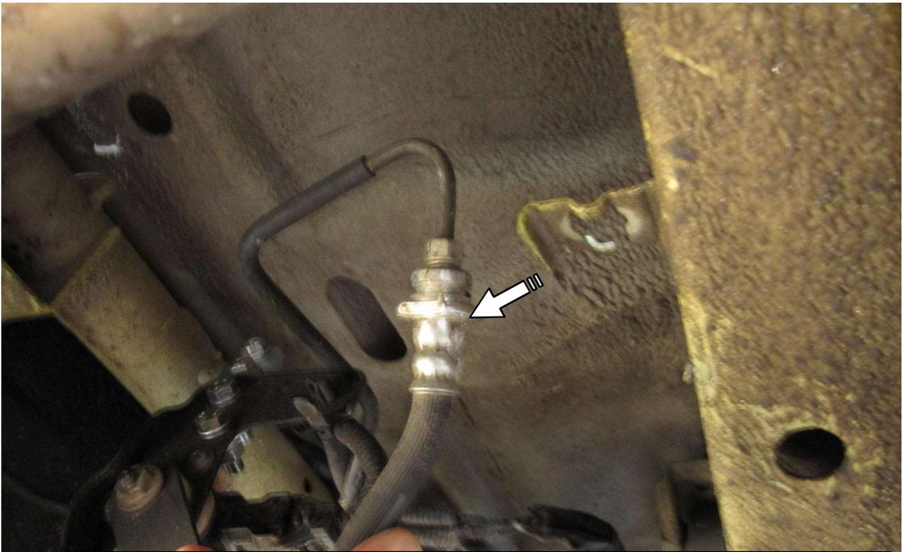
**Bremsleitung aus Halter nehmen indem sie entweder den Halter aufschneiden oder die Bremsleitung trennen.**
