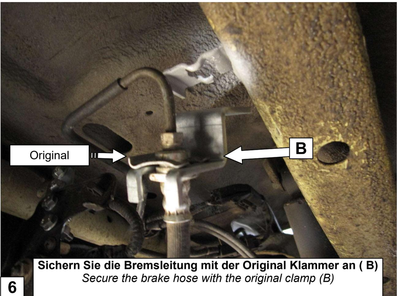
**Sichern Sie die Bremsleitung mit der Original Klammer an ( B )**
