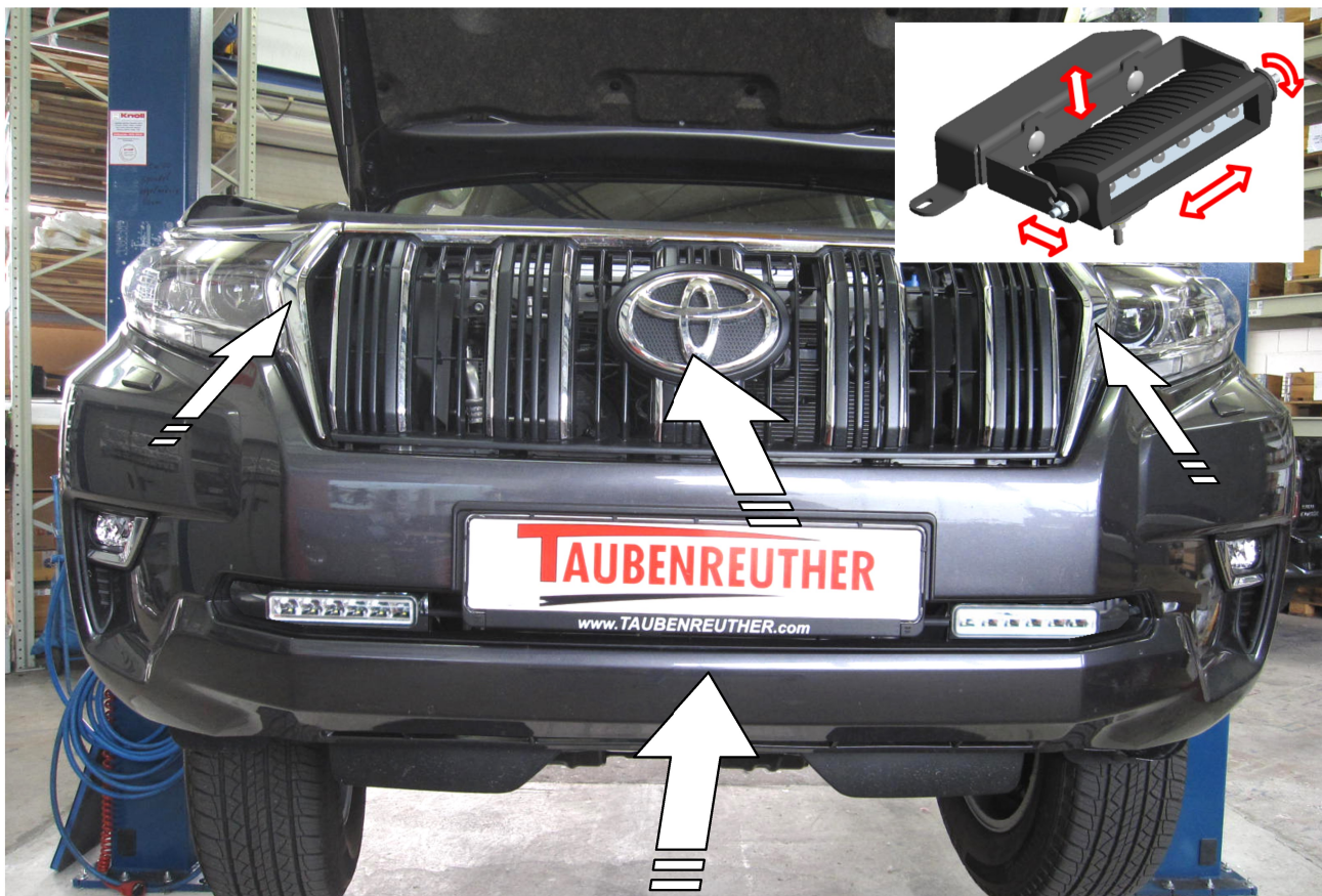
12 Scheinwerfer ausrichten! / Adjust the spots! Stoßfänger, Kühlergrill und Zierblenden wieder montieren! Mount the bumper, cooling grille and the decorative panels again!
