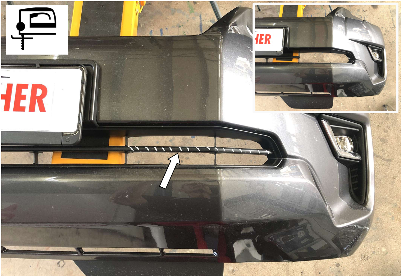
11 Steg wegschneiden! / Cut away the bar! Das Gleiche an der rechten Seite! / The same at the right!
