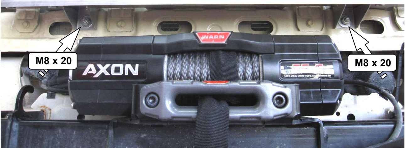
11 Jetzt alle Schrauben festziehen! / Tighten all screws now!
