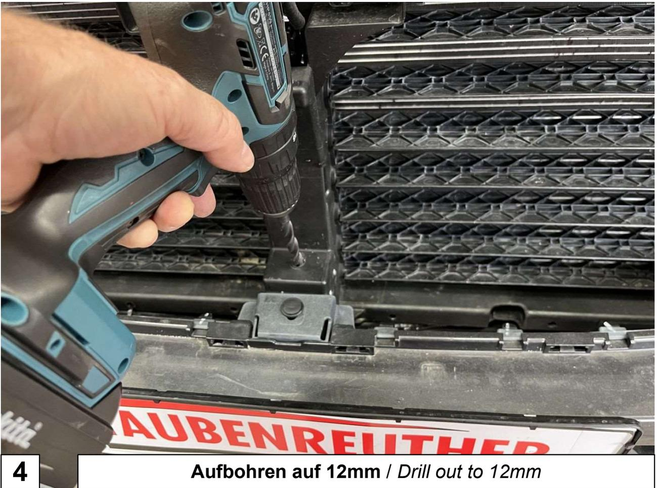
**4**      **Aufbohren auf 12mm / Drill out to 12mm**
