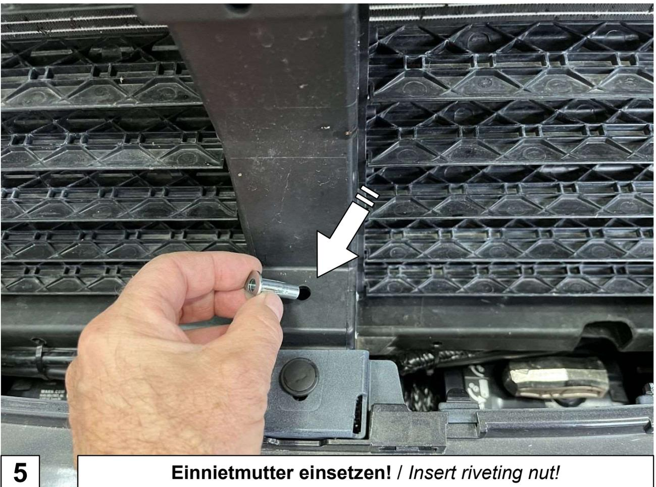
**5**      **Einnietmutter einsetzen! / Insert riveting nut!**
