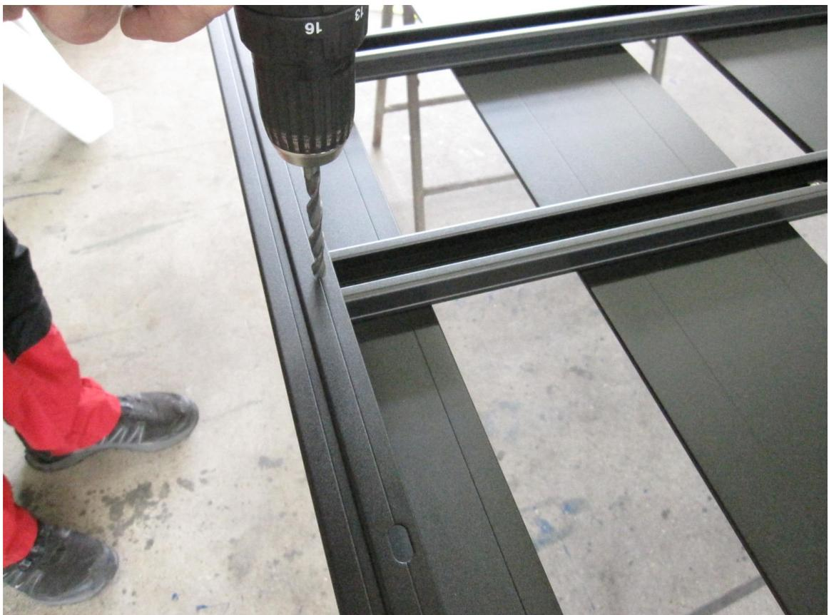
**Zusätzliche Befestigungsbohrungen einbringen (mit. Ø8)!
