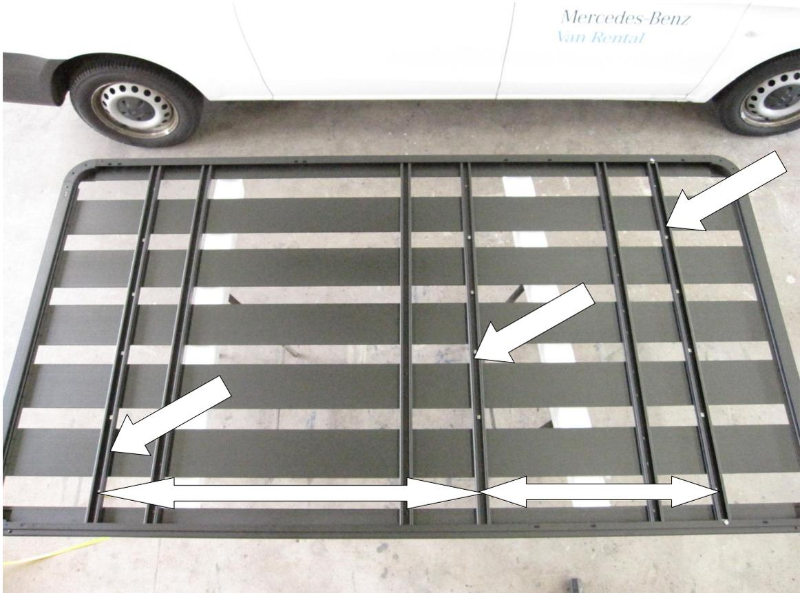
**Zusätzliche Streben gemäß Fahrzeuglänge und Plattform ausrichten!
