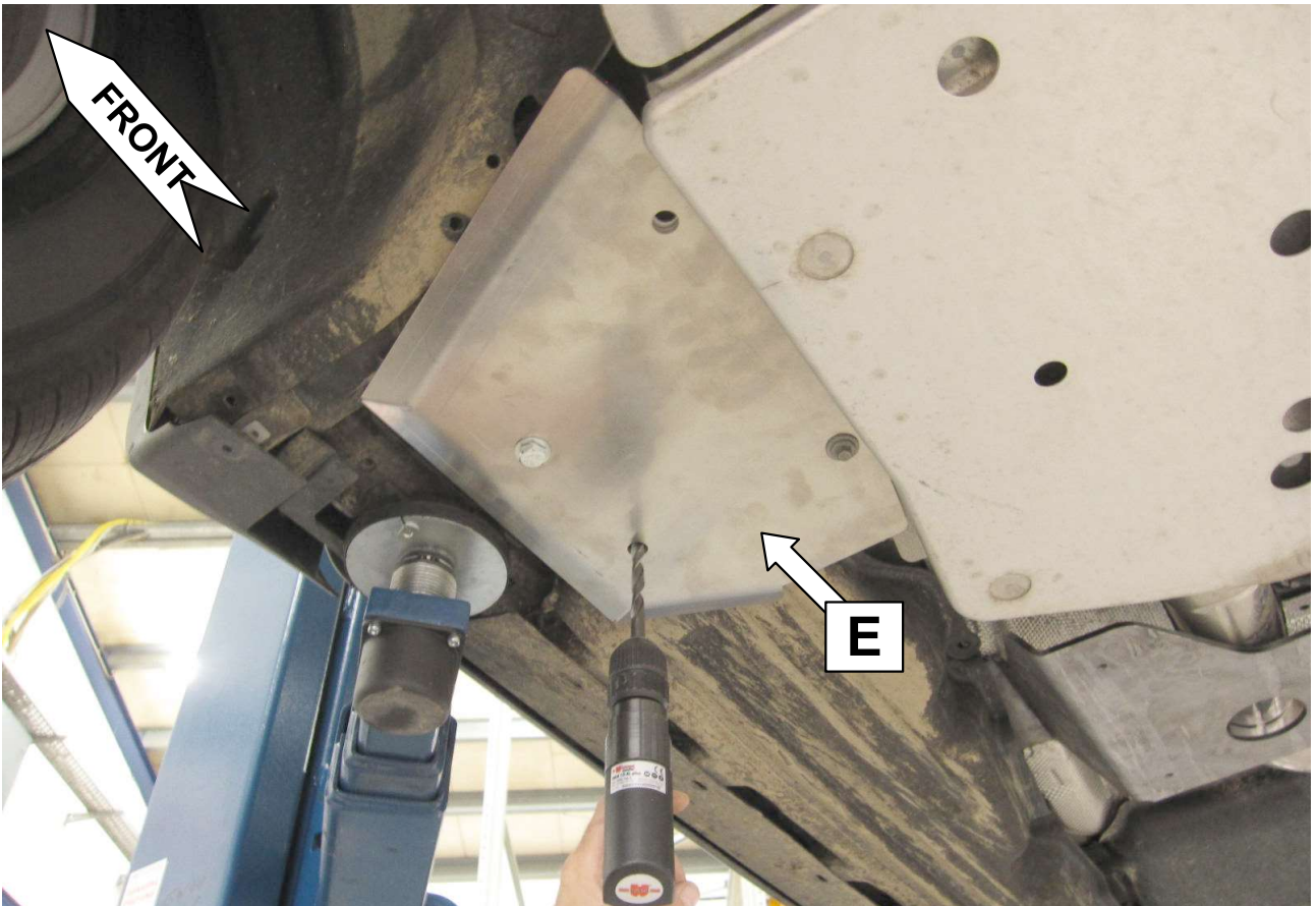
9 Rechte Seite vorne. Bohren durch den Kunststoffschutz min. Ø 21mm/ Right side in front. Drill in plastic protection min. Ø 21mm!
