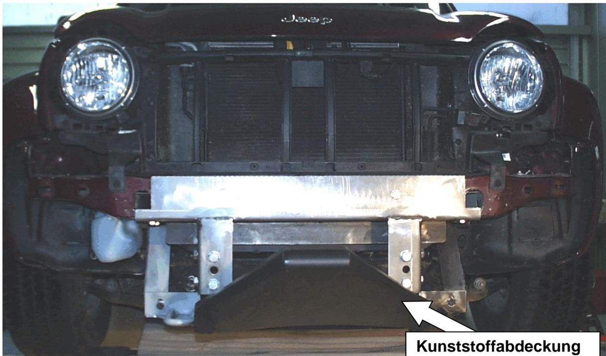
**Hier sehen sie den fertig montierten Schneepflugabstützsatz.
